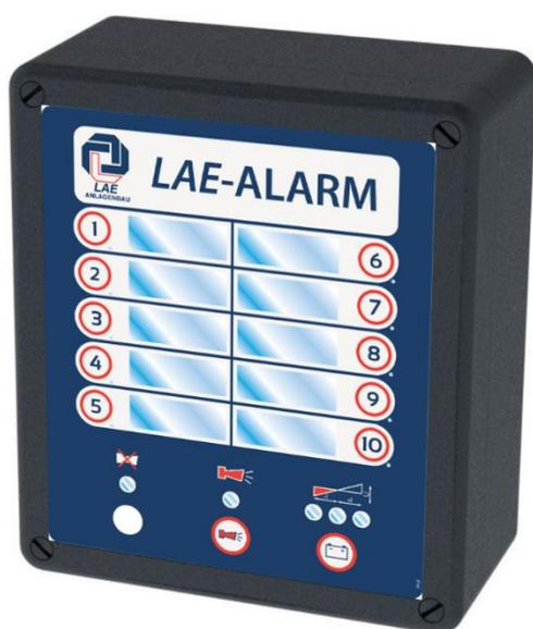
Wenn ein Alarm auftritt, werden der Schaltkontakt und die angeschlossene Sirene aktiviert. Ist die Ursache des Alarms behoben, geht das Alarmpaneel wieder in Ruhe, jedoch leuchtet die Lampe der betreffenden Gruppe auf, bis das Alarmpaneel rückgesetzt wird. Hierdurch sind aufgetretenen Störungen einfach nachvollziehbar. Bei Ausfall der Netzspannung tritt automatisch ein Alarm auf.
